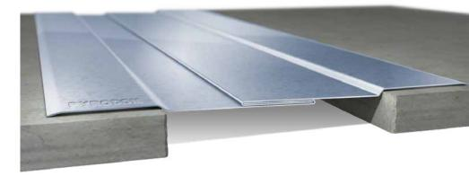
Schutz vor mechanischen Einwirkungen. In allen drei Achsen frei beweglich, kompensiert PYRODOM®-BWF problemlos auch extreme Wand- und Deckenbewegungen von zum Beispiel 50 mm. Der Einsatz an Scherfugen zwischen Wand und Decke ist uneingeschränkt möglich.
