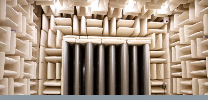
Das 400 t schwere Testlabor ist eine Raum-in-Raum-Konstruktion mit zwei Schallmessräumen. In dem einen werden Messungen auf der Saug- und in dem anderen Messungen auf der Ausblasseite des Ventilators vorgenommen. Ein Kanalsystem verbindet beide Räume und leitet den Luftstrom aus dem getesteten Ventilator wieder zur Saugseite. Dabei lassen sich Luftmenge sowie Luftdruck, -feuchte und -temperatur optimal erfassen und messen. Damit von außen keinerlei Geräusche
