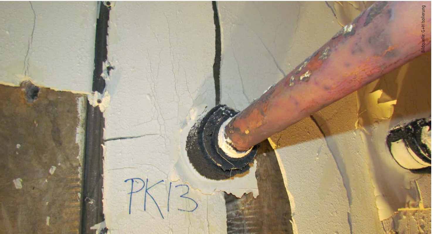
Abb 1: Klassifizierte Rohrabschottung PYROSTAT UNI nach DIN 4102-11 und EN 1366-3 von G+H Isolierung in leichter Trennwand
