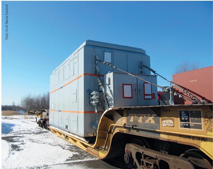
Abb. 2: Mit SONEX-T ummantelter Trafo inklusive Abluftschalldämpfer
