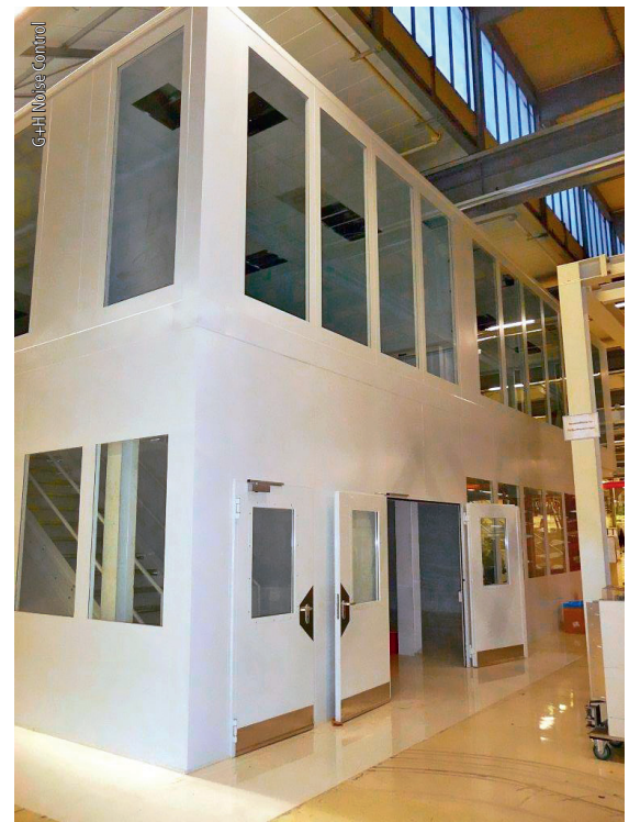
Abb. 4: Individuell entwickelte zweigeschossige Schallschutzkabine
