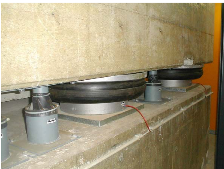
Prüfstand auf Luftfedern mit separaten Viskositätsdämpfern
