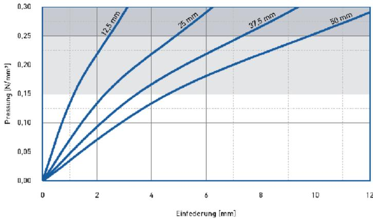
Aufgezeichnet wurde jeweils die 3. Belastung. Prüfung bei Raumtemperatur zwischen ebenen Stahlplatten. Prüfgeschwindigkeit  $v=1\%$  der Dicke pro Sekunde, Formfaktor  $q=3$
