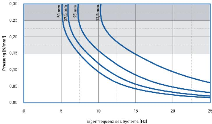
Eigenfrequenz eines Systems, bestehend aus einer kompakten Masse und einer elastischen Lagerung aus **vibradyn® S150** auf starrem Untergrund, Formfaktor  $q=3$
