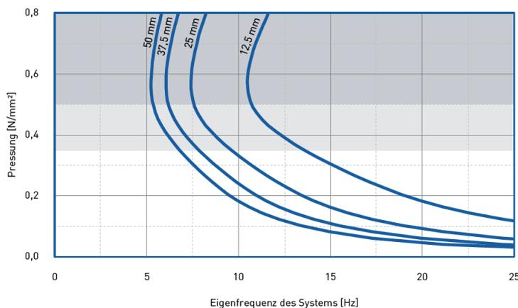
Eigenfrequenz eines Systems, bestehend aus einer kompakten Masse und einer elastischen Lagerung aus **vibradyn® S350** auf starrem Untergrund, Formfaktor  $q=3$
