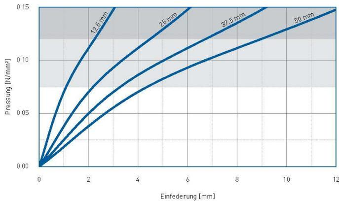
Aufgezeichnet wurde jeweils die 3. Belastung. Prüfung bei Raumtemperatur zwischen ebenen Stahlplatten. Prüfungsgeschwindigkeit  $v=1\%$  der Dicke pro Sekunde, Formfaktor  $q=3$
