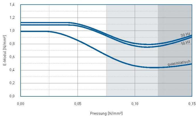
Dynamische Prüfung: harmonische Anregung mit einer Amplitude von  $\pm 0,11$  mm bei 10 Hz und  $\pm 0,04$  mm bei 30 Hz. Quasistatischer E-Modul: Tangentenmodul aus der Federkennlinie. Messung in Anlehnung an DIN 53513, Formfaktor  $q=3$
