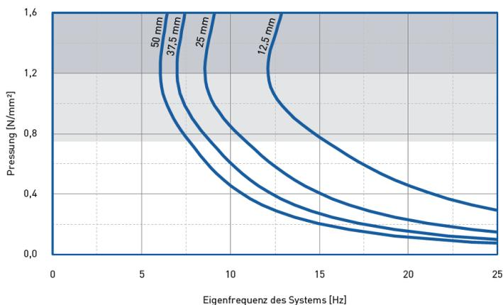
Eigenfrequenz eines Systems, bestehend aus einer kompakten Masse und einer elastischen Lagerung aus **vibradyn® S750** auf starrem Untergrund, Formfaktor  $q=3$
