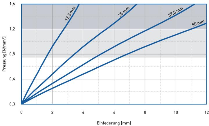
Aufgezeichnet wurde jeweils die 3. Belastung. Prüfung bei Raumtemperatur zwischen ebenen Stahlplatten. Prüfgeschwindigkeit  $v=1\%$  der Dicke pro Sekunde, Formfaktor  $q=3$
