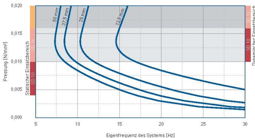
Eigenfrequenz eines Systems, bestehend aus einer kompakten Masse und einer elastischen Lagerung aus **vibrafoam® SD10** auf starrem Untergrund, Formfaktor  $q=3$
