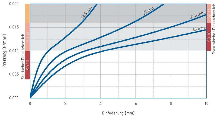
Aufgezeichnet wurde jeweils die 3. Belastung. Prüfung bei Raumtemperatur zwischen ebenen Stahlplatten.
