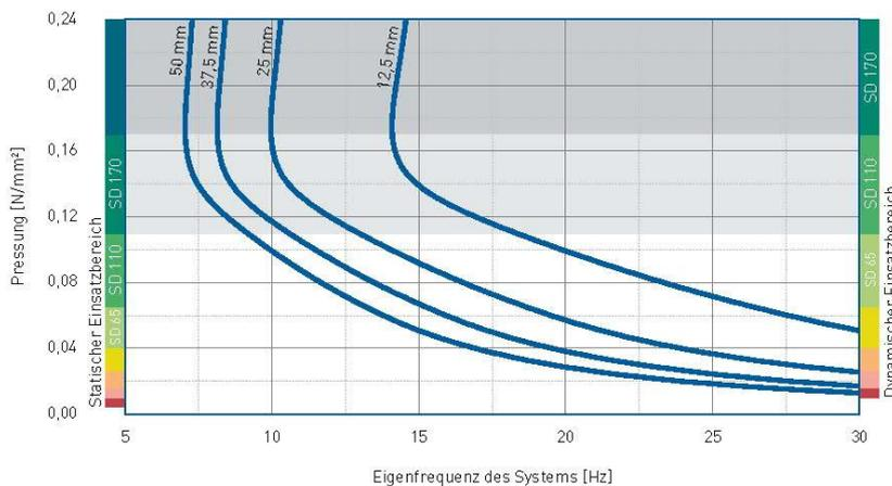
Eigenfrequenz eines Systems, bestehend aus einer kompakten Masse und einer elastischen Lagerung aus **vibrafoam® SD110** auf starrem Untergrund, Formfaktor  $q=3$
