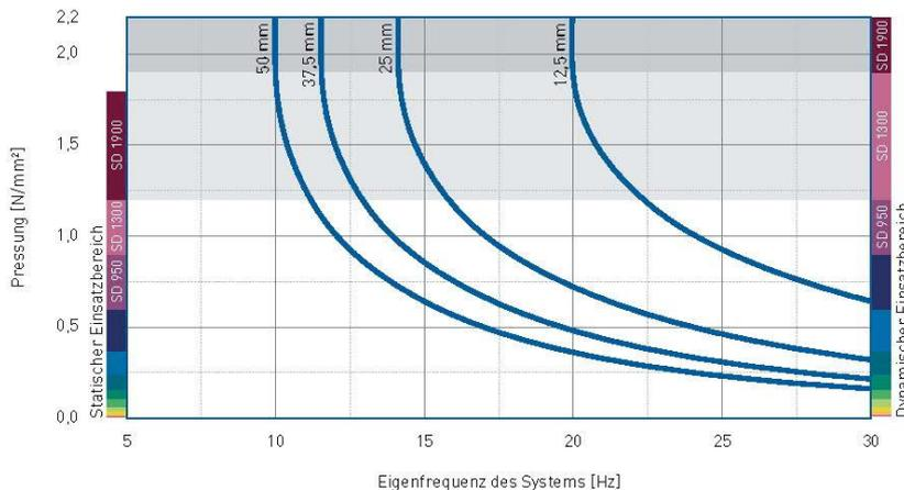
Eigenfrequenz eines Systems, bestehend aus einer kompakten Masse und einer elastischen Lagerung aus **vibrafoam® SD1300** auf starrem Untergrund, Formfaktor  $q=3$
