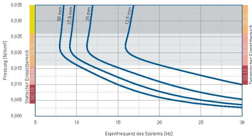
Eigenfrequenz eines Systems, bestehend aus einer kompakten Masse und einer elastischen Lagerung aus **vibrafoam® SD16** auf starrem Untergrund, Formfaktor  $q=3$
