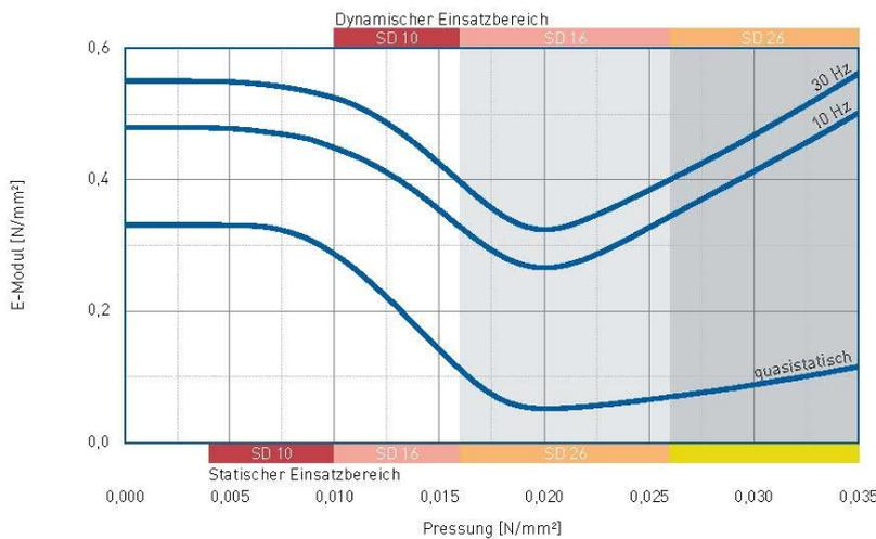
Dynamische Prüfung: harmonische Anregung mit einer Amplitude von  $\pm 0,22$  mm bei 10 Hz und  $\pm 0,08$  mm bei 30 Hz. Quasistatischer E-Modul: Tangentenmodul aus der Federkennlinie. Messung in Anlehnung an DIN 53513, Formfaktor  $q=3$
