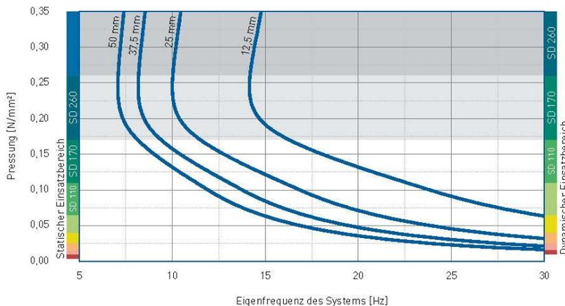
Eigenfrequenz eines Systems, bestehend aus einer kompakten Masse und einer elastischen Lagerung aus **vibrafoam® SD170** auf starrem Untergrund, Formfaktor  $q=3$
