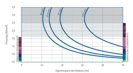
Eigenfrequenz eines Systems, bestehend aus einer kompakten
