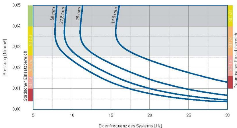
Eigenfrequenz eines Systems, bestehend aus einer kompakten Masse und einer elastischen Lagerung aus **vibrafoam® SD26** auf starrem Untergrund, Formfaktor  $q=3$
