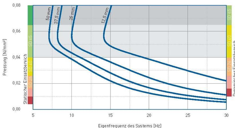
Eigenfrequenz eines Systems, bestehend aus einer kompakten Masse und einer elastischen Lagerung aus **vibrafoam® SD40** auf starrem Untergrund, Formfaktor  $q=3$
