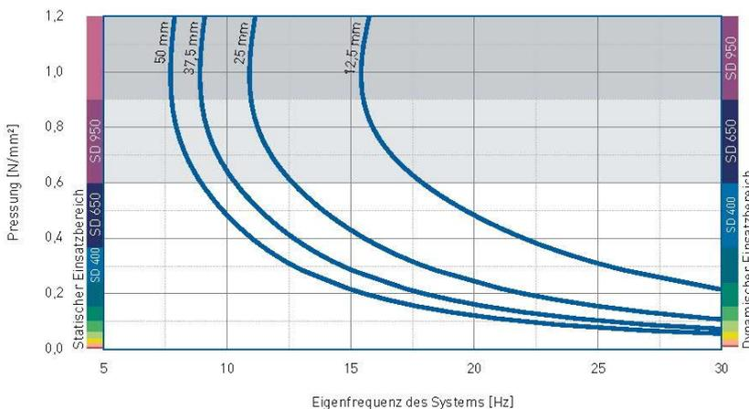
Eigenfrequenz eines Systems, bestehend aus einer kompakten Masse und einer elastischen Lagerung aus **vibrafoam® SD650** auf starrem Untergrund, Formfaktor  $q=3$
