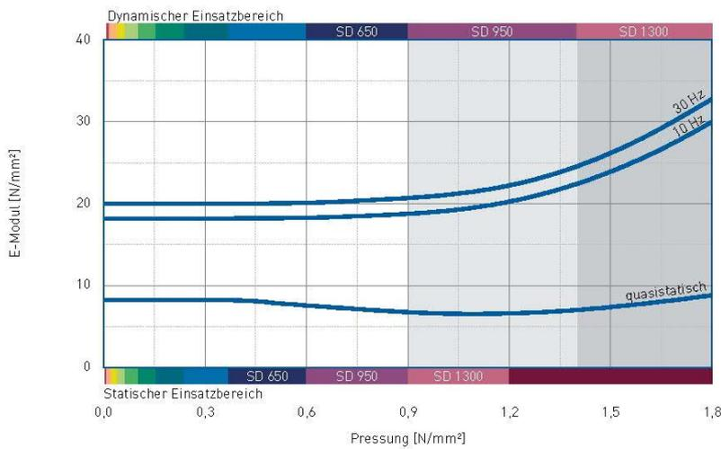
Dynamische Prüfung: harmonische Anregung mit einer Amplitude von  $\pm 0,22$  mm bei 10 Hz und  $\pm 0,08$  mm bei 30 Hz. Quasistatischer E-Modul: Tangentenmodul aus der Federkennlinie. Messung in Anlehnung an DIN 53513, Formfaktor  $q=3$
