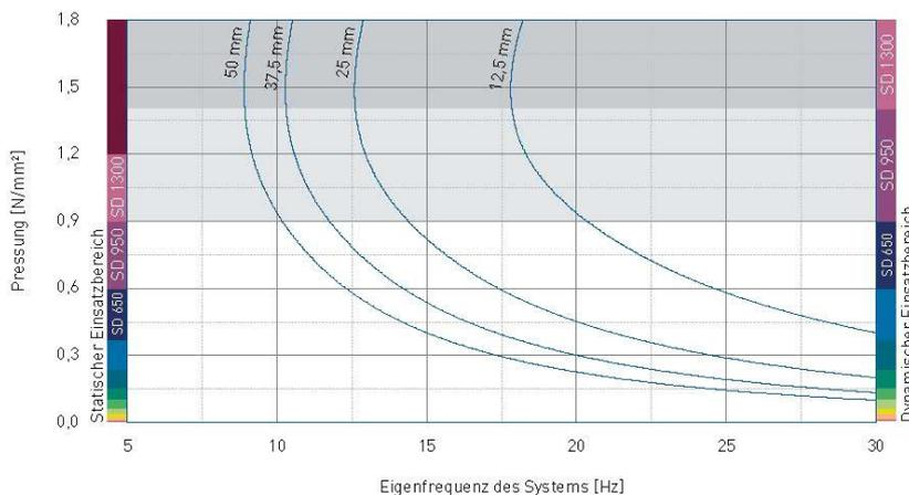
Eigenfrequenz eines Systems, bestehend aus einer kompakten Masse und einer elastischen Lagerung aus **vibrafoam® SD950** auf starrem Untergrund, Formfaktor  $q=3$
