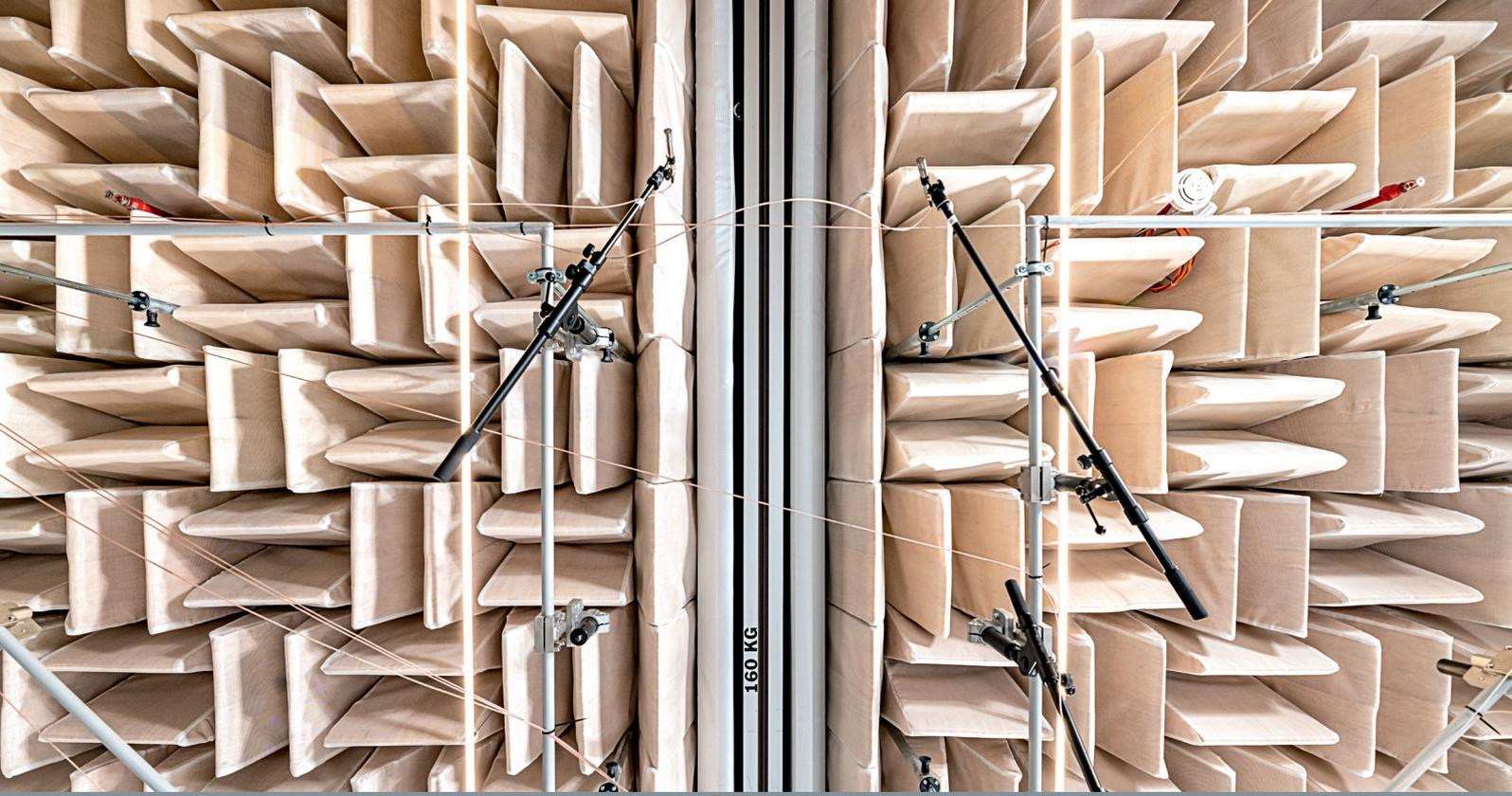
Bei der Auskleidung des reflexionsarmen Halbraums, der eine hohe Schalldämmung bietet, kam eine Hybridausführung der bewährten G+H Keilabsorbertechnik ASONAD® zum Einsatz – sowohl Lochblech – als auch Mineralwollekeile. Die eingesetzten Lochblechkeile wurden auf die speziellen Kundenanforderungen angepasst. Eine Verwendung von Keilabsorbentern dämmt Schall-Reflexionen ein und verkürzt die Nachhallzeit von Klängen maßgeblich. Zusätzlich baute das G+H-Team eine kombinierte Schall- und Brand-
