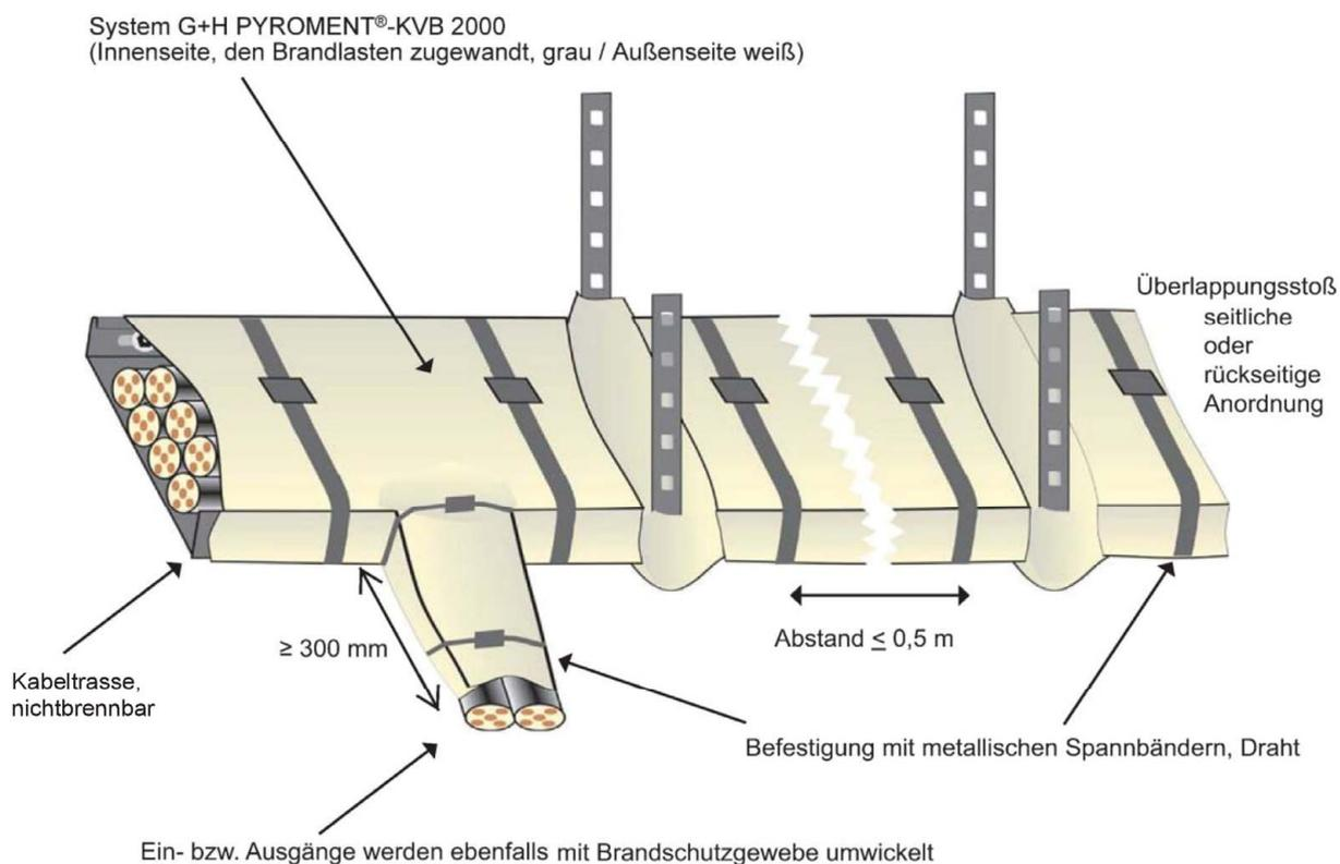
Umhüllungen von elektrischen Leitungen und Leitungsanlagen mit dem Brandschutzgewebe "System G+H PYROMENT KVB 2000"
