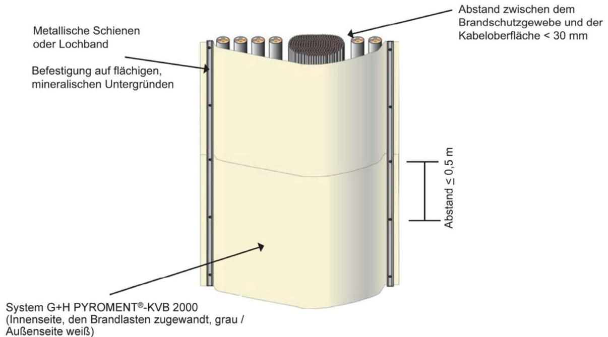
**Umhüllungen von elektrischen Leitungen und Leitungsanlagen mit dem Brandschutzgewebe "System G+H PYROMENT KVB 2000"**
