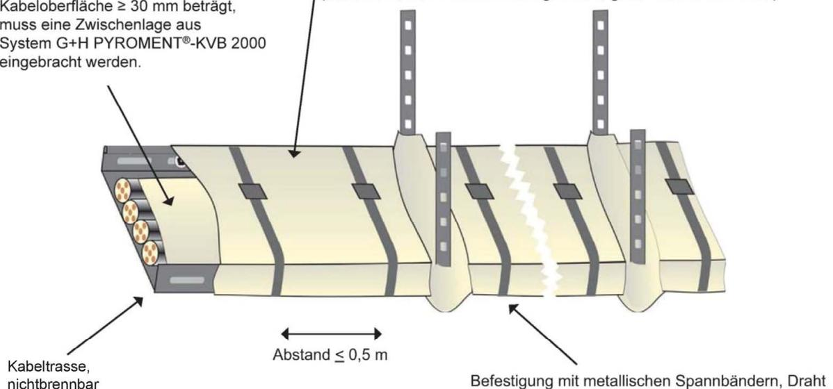
Umhüllungen von elektrischen Leitungen und Leitungsanlagen mit dem Brandschutzgewebe "System G+H PYROMENT KVB 2000"
