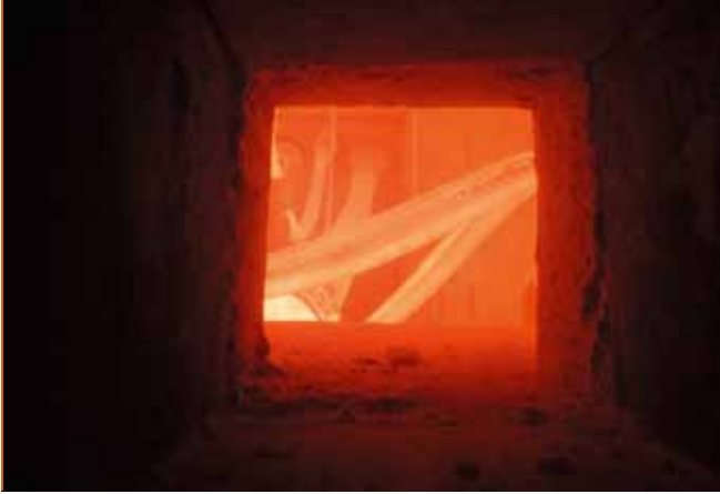
Abb. 2: Während des Brandversuchs am 11. April 2012: Ansicht der Durchbiegungen der Rohre auf der Feuerseite
